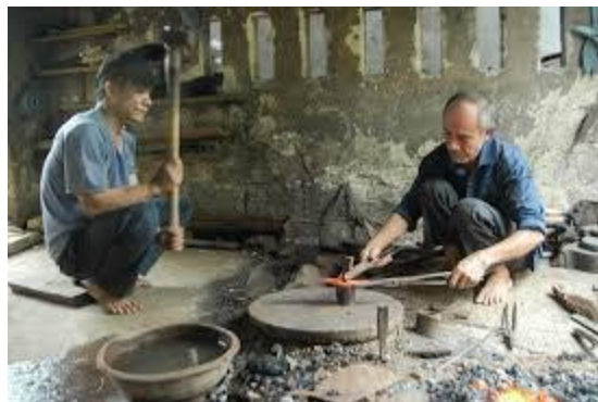
Công nhân dùng Búa Đe để chế tạo khí cụ nhật dụng và sản xuất
